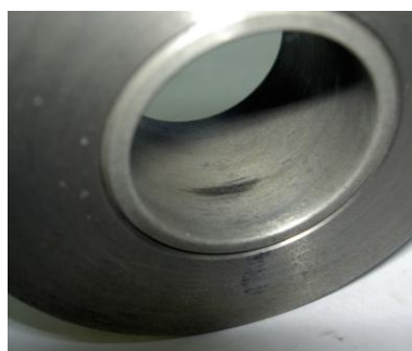
Рис. 17. Втулка подшипника из КМ (состав см. в табл. 6)
