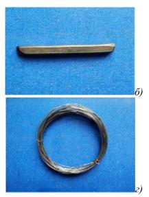
Рис.1. а — слиток после первой прокатки в калибрах; б — заготовка после прокатки в калибрах; в - пруток после ротационной ковки; г - проволока после волочения.
