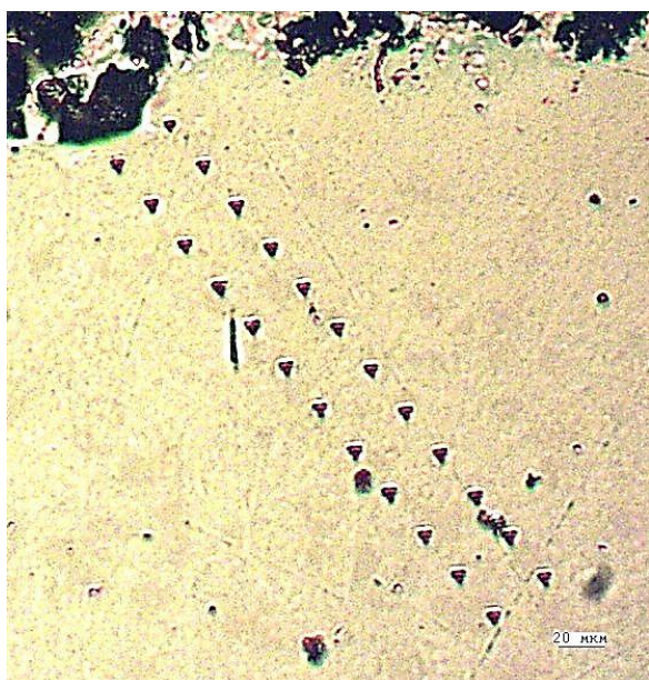
Рисунок 10 – Фотография и типичная кривая индентирования
