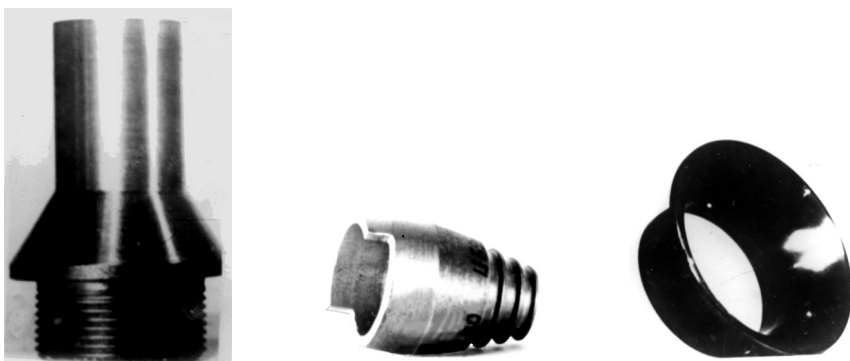
Рис. 3. Большеразмерные детали из разработанных вольфрамовых сплавов, полученные по литейной технологии. Прочность литых сплавов различного состава, при 1800, 2000 и 2300 °С, колеблется в пределах 350-450, 220-350 и 150-200 МПа соответственно.
