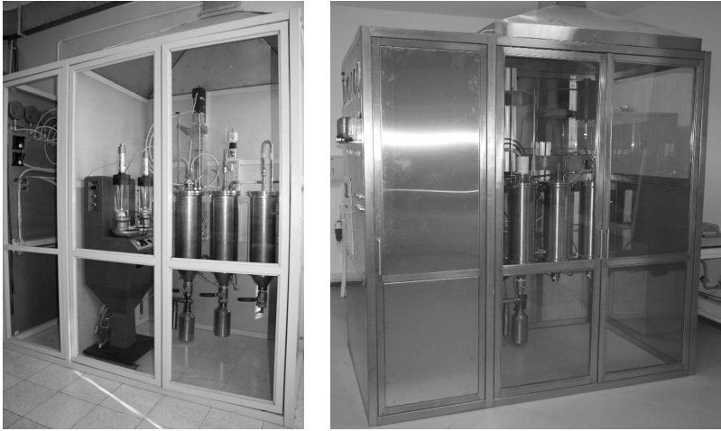
Рис. 6. Лабораторные установки плазмохимического синтеза нанопорошков, 2008 – 2018 годы.
