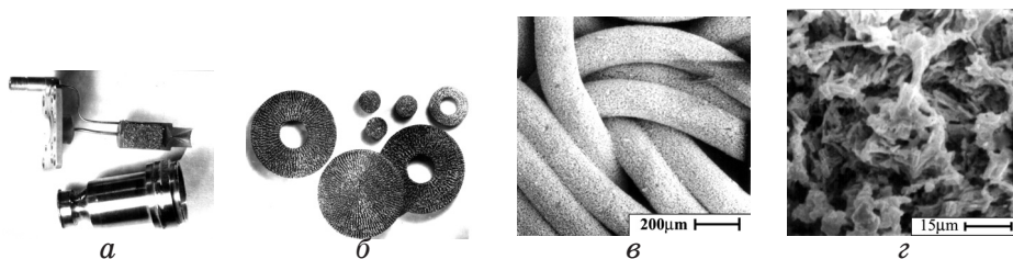
Рис. 4. Каталитические элементы (а – в) из высокоренийевого сплава Mo-10Mo-45Re, поверхность каталитических элементов после окислительно-восстановительной обработки в специальных средах (в, г).
