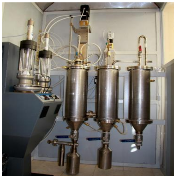
Рис.2. Общий вид плазменной установки с реактором с ограниченным струйным течением на базе ЭД плазматрона мощностью 30 кВт.
